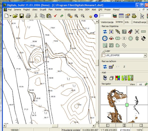
Izrada Digitalnog Modela terena se radi na osnovi prikupljenih detaljnijih tačaka i strukturalnih linija. DTM se može formirati u TIN ili GRID obliku. Na osnovi DTM-a se generišu izohipse. Mogu se definisati površine za koje se ne želi prikaz izohipsi (zgrade, putevi).
