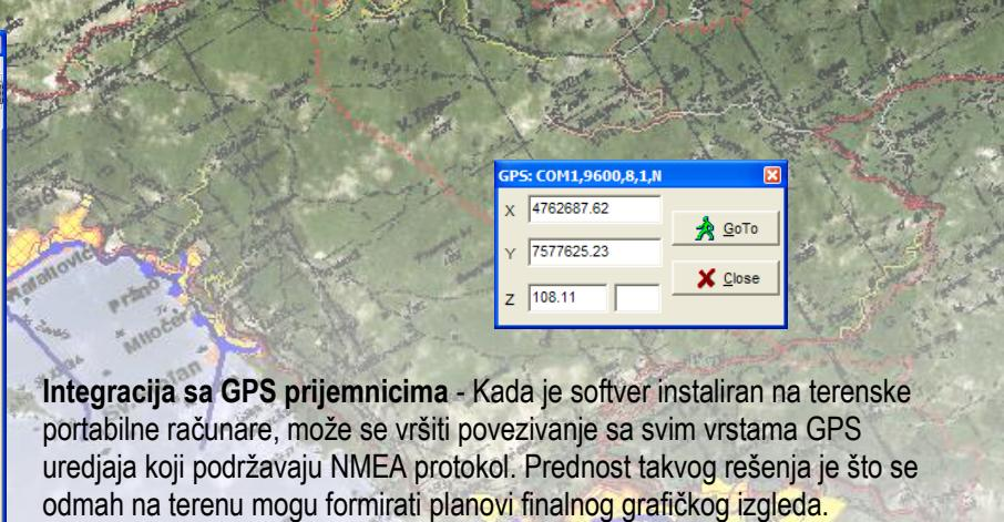
**Integracija sa GPS prijemnicima** - Kada je softver instaliran na terenske portabilne računare, može se vršiti povezivanje sa svim vrstama GPS uređaja koji podržavaju NMEA protokol. Prednost takvog rešenja je što se odmah na terenu mogu formirati planovi finalnog grafickog izgleda.
